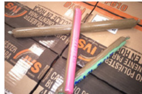
Los cartuchos de resina de poliéster de dos componentes son fundamentales para los pernos de anclaje de roca a los estratos circundantes en minas subterráneas.
